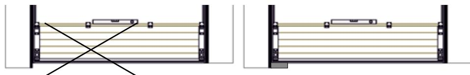
Označené otvory vyvrtáme vrtákem ø 12mm, do otvoru vložíme hmoždinky. Svislé kolejnice vyvážíme pomocí vodováhy a přišroubujeme.
